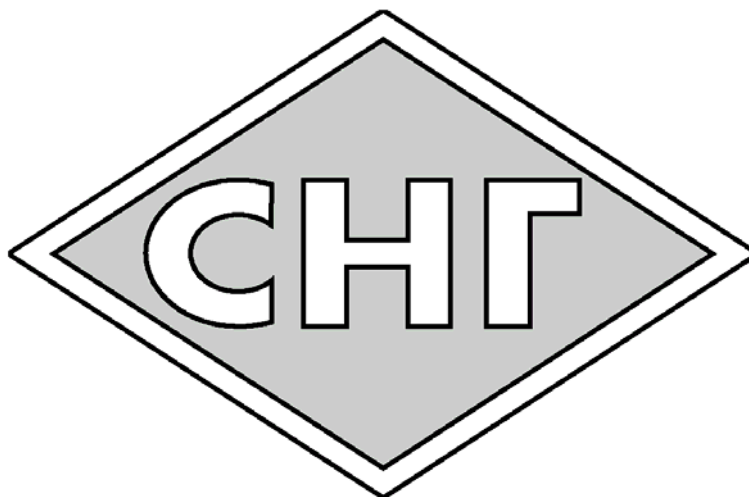
Рисунок 4.4 - Образец опознавательного знака КТС категорий М2 и М3, использующих в качестве топлива сжиженный нефтяной газ (СНГ) или сжатый природный газ (СПГ)
