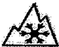
Рисунок 5.1. Маркировка, наносимая на зимнюю шину
